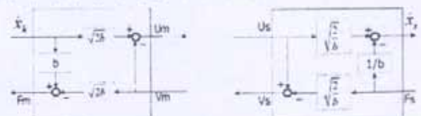
(a) 주로봇단의 웨이브 변환 (b) 종로봇단의 웨이브 변환 그림 2. 웨이브 변환 구조
