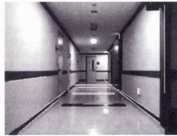
〈그림 1〉 수직선, 바닥선, 소실점 모두 SLAM을 위한 특징정보(feature)로 사용된다.
