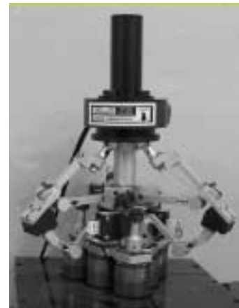
그림 2. 6 자유도 병렬형 햅틱장치. Fig. 2. New 6-DOF parallel haptic device.
